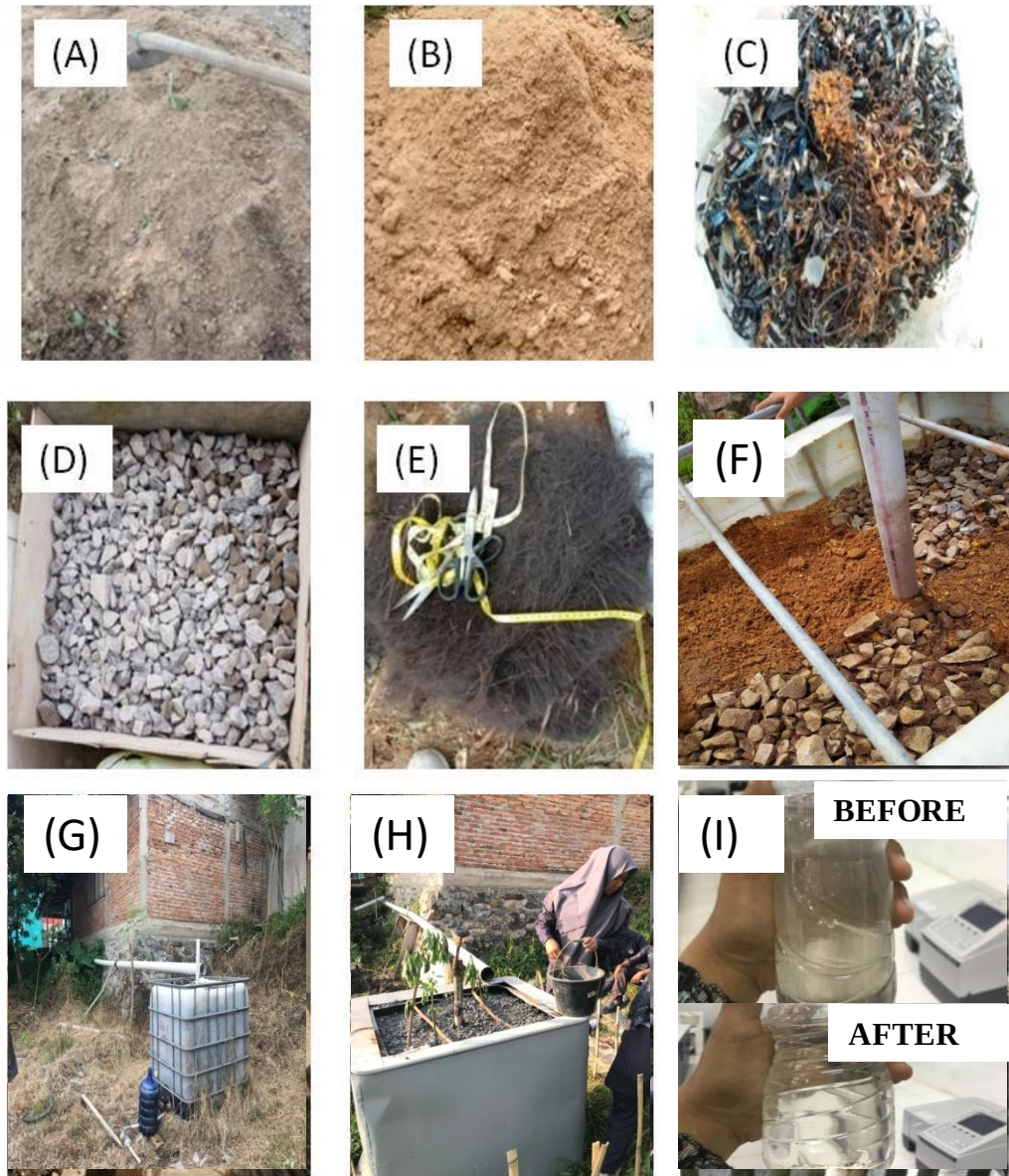
Figure 2. Bahan untuk Inovasi Cerdas Ekoteknologi STBM6-4P, Sumber Air Limbah dari Rumah makan dan STBM6-4P tipe kotak zig zag: (A) Tanah lokal, (B) serbuk gergaji, (C) Limabh besi mesin bubut, (D) batu pecah, (E) Ijuk (F) susunan material STBM6-4P (G) Air limbah rumah makan masuk melalui pipa PVC ke STBM6-4P, (H) Kuliah Praktek Lapangan mahasiswa di STBM6-4P dan (I) Air limbah Rumah makan sebelum dan sesudah dimurnikan STBM6-4P.
